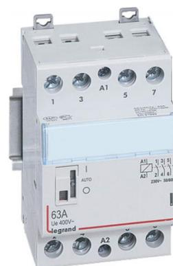
La tension nominale du circuit de commande devra impérativement être en 230V. La puissance dissipée par contact est de 3.5W. Il est donc à noter que la mise en place d'un contacteur consommera 2.4kW/an pour un 2 pôles et 5kW/an pour un 4 pôles. Voir fiches techniques et référence en annexe.
